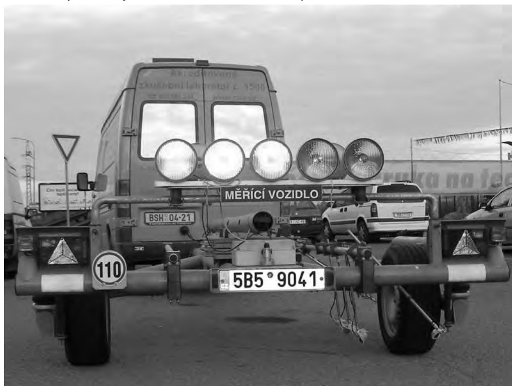
Obr. 2. Umístění jednotlivých měřících mikrofonů na přívěsu CPX.
