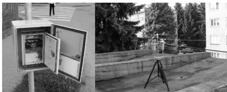
Obr. 2. Radarové sčítacie zariadenie SIERZEGA SR4 (vľavo) a meteorologická stanica WS 888 (vpravo).
