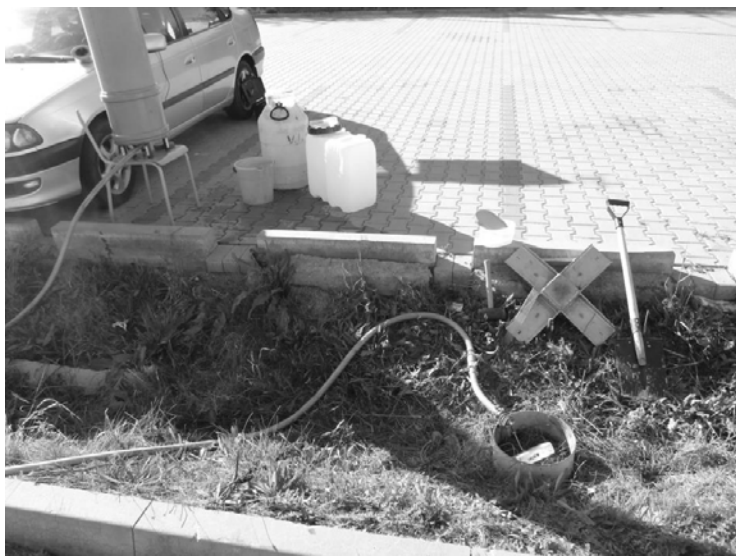
Obr. 2: Měření infiltrace v terénu (zdroj: VÚT, VÚV T.G.M.)
