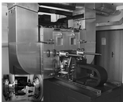
Obr. 2: Testovací dynamometr frikčních vlastností automobilových brzdových destiček
