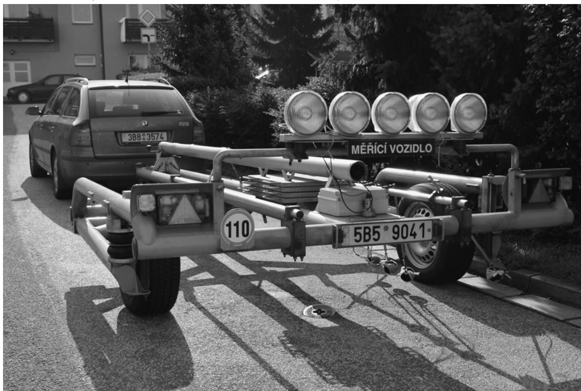
Obr. 1: Celkový pohled na měřicí přívěs CPX s tažným vozidlem.
