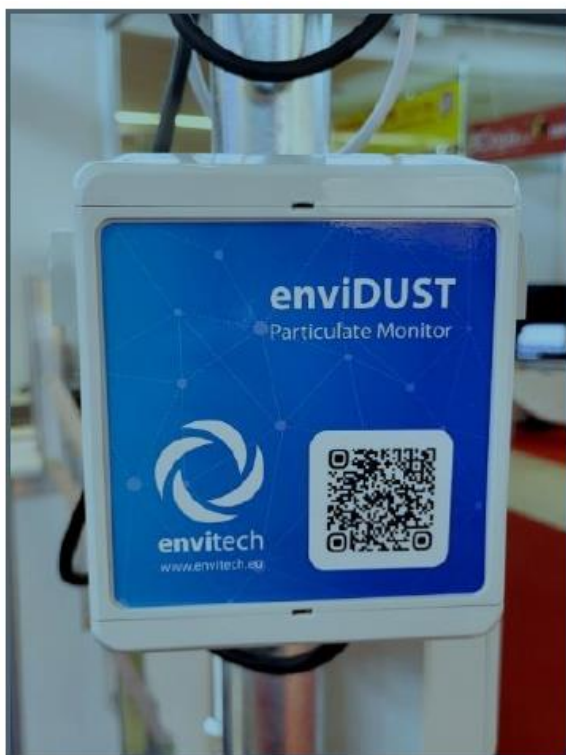
Obr. 2. Prachoměrná senzorická jednotka enviDUST, senzorická meteostanice enviMET
