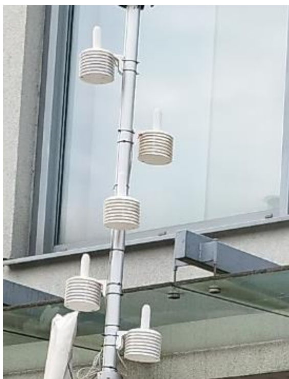
Obr. 2. Smart senzory používané v rámci projektu REMoT pre monitorovanie kvality ovzdušia, meteorologických parametrov, hluku a osvetlenia
