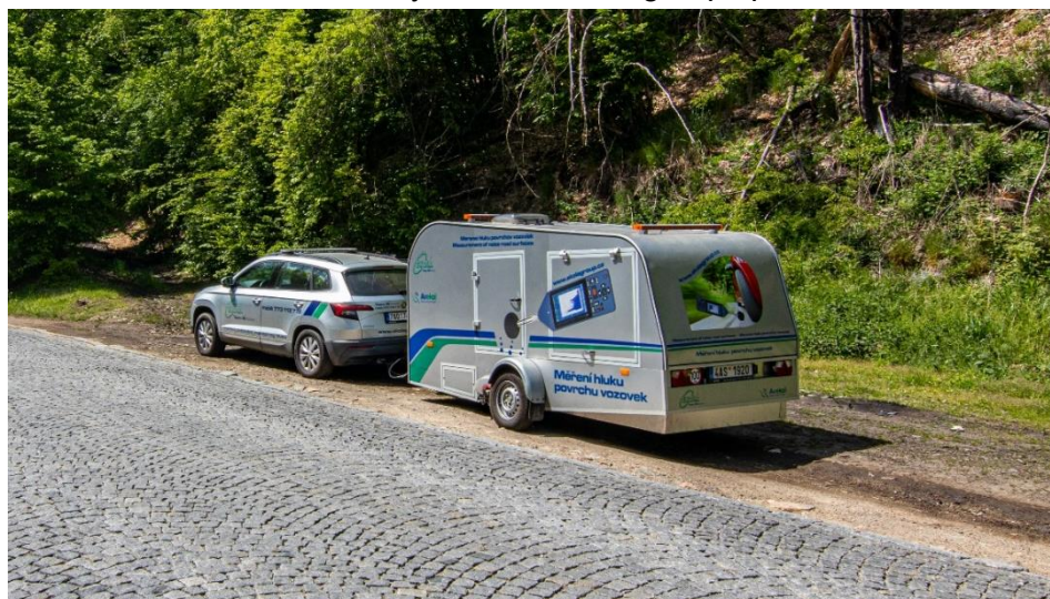
Obr.3. Ukázka uzavřeného měřicího systému EKOLA group spol. s r.o., CPX metoda
