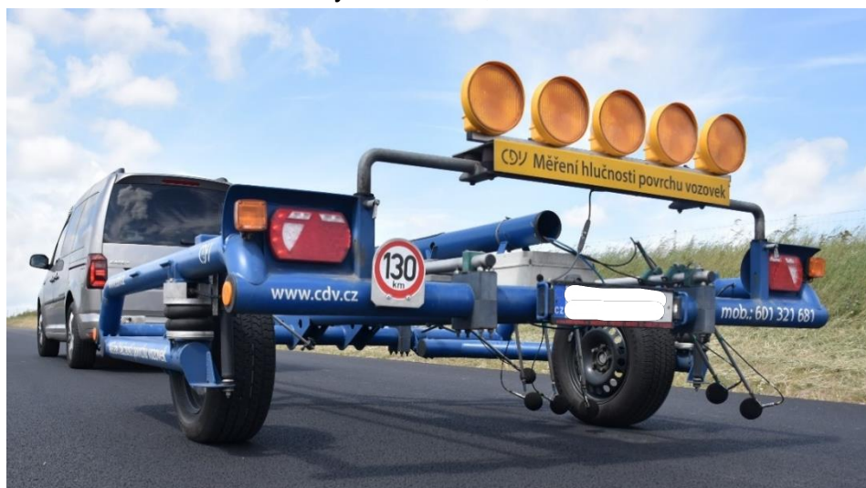
Obr.2. Ukázka otevřeného měřicího systému CDV, CPX metoda
