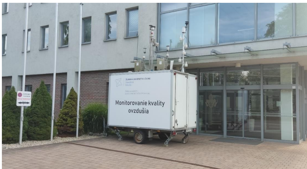
Obr. 4 Porovnávacie merania smart senzorov SM na meracom stanovišti v centre mesta Žilina
