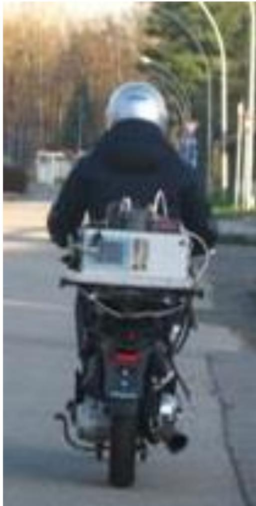
Miniaturní a nízkonákladová přenosná zařízení pro měření emisí za provozu
